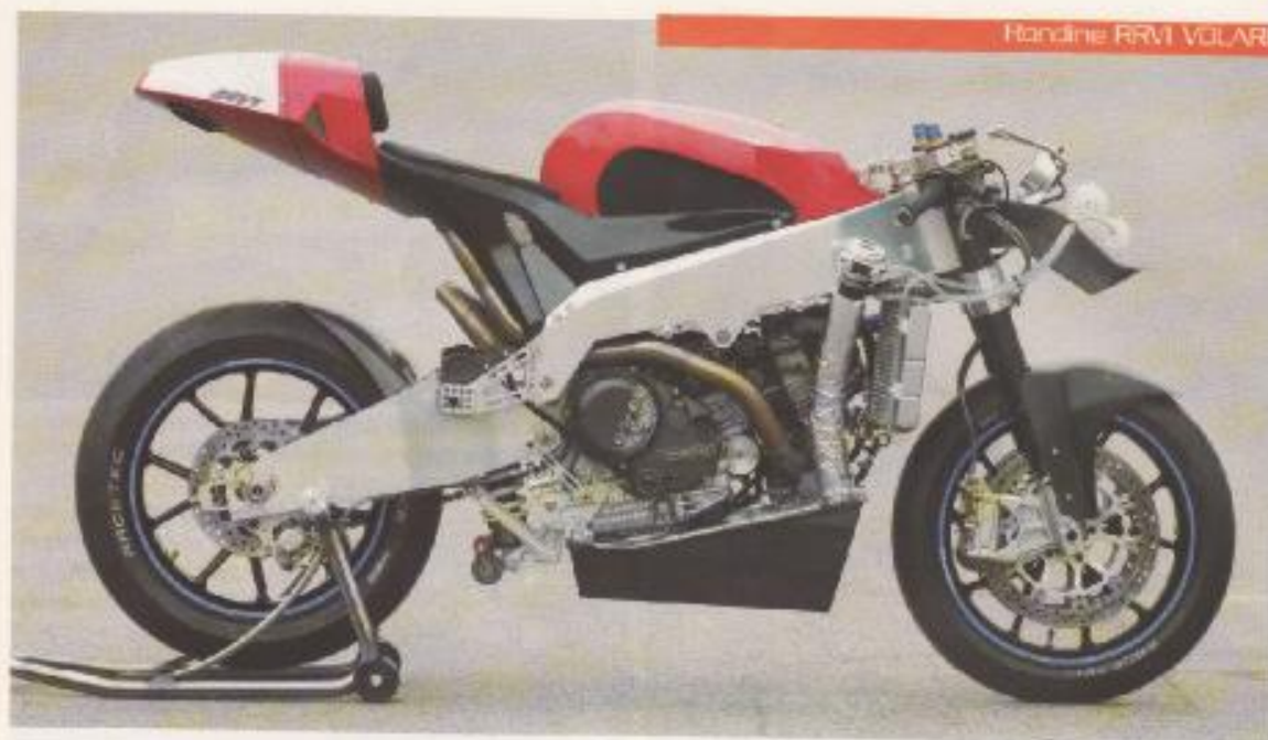
La curiosità dei nostri lettori probabilmente aspettava solo queste foto, che rivelano nell'insieme la tecnologia nascosta sotto la carenatura. Già si notano dei particolari interessanti come la disposizione, ruotata all'indietro, del motore.
